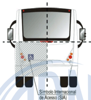
Figura 12 — Exemplo de localização do SIA na parte traseira no veículo
